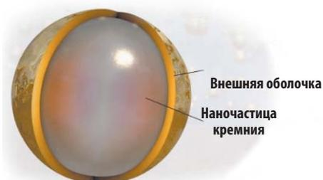
Рис. 5. Схема строения наночастиц кремния с золотым покрытием [19]
